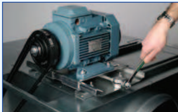
Support moteur facilitant le réglage de tension de la courroie.
