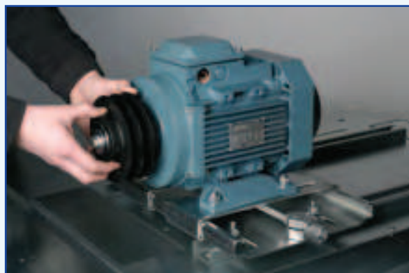
Support moteur facilitant le réglage de tension de la courroie.
